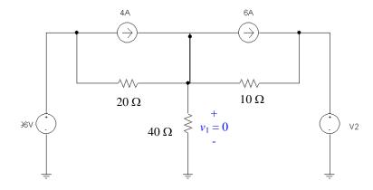
$$4 - 6 = v_1/40 + (v_1 - 96)/20 + (v_1 - V_2)/10$$
