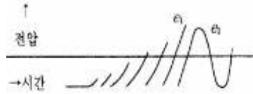
<그림> 반복 재발호에 의한 전압증폭(Voltage Build Up) 파형
